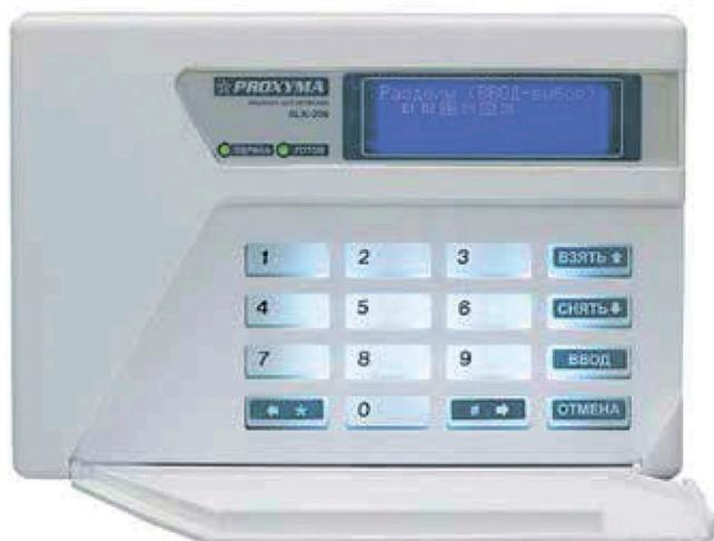
Клавиатура имеет 16 клавиш: 10 цифровых (0...9) - используются для ввода цифр, 4 - функциональные, выполняющие действия «ВЗЯТЬ», «СНЯТЬ», «ВВОД» и «ОТМЕНА», 2 - содержат спецсимволы «#>» и «\*<», которые используются при вводе команд и для пролистывания меню.
